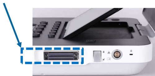
Figura 3. Port pe partea laterală a unui traductor conectat direct
